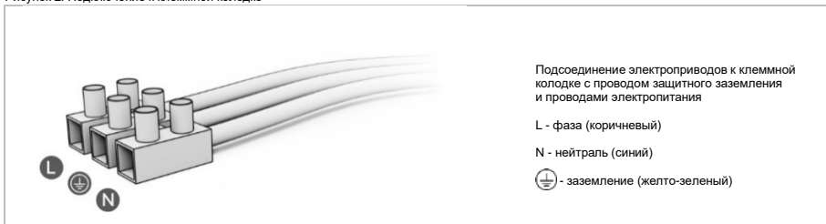
Рисунок 2. Подключение к клеммной колодке
